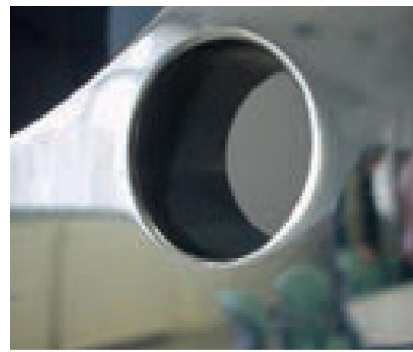
Фото 3. Крепежное отверстие диаметром 32 мм для двухкомпонентных втулочных гаек
